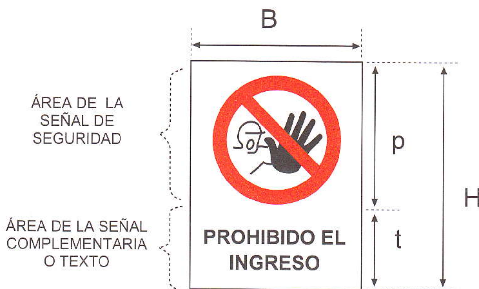
Figura 1b - Dimensiones de la señal de seguridad
